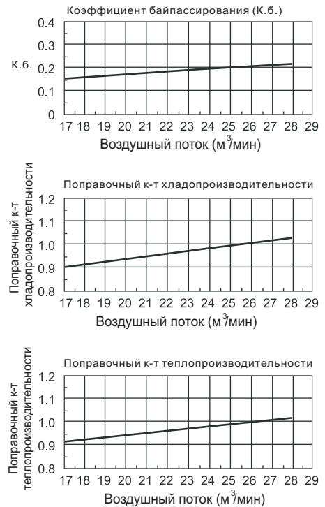
Зависимость к-та байпасирования и поправочного к-та от интенсивности охлаждающего воздушного потока
